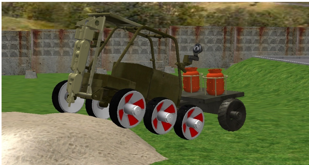
Рис. 10. Движение модели колесного робота КРТ-100МП по сложному рельефу
