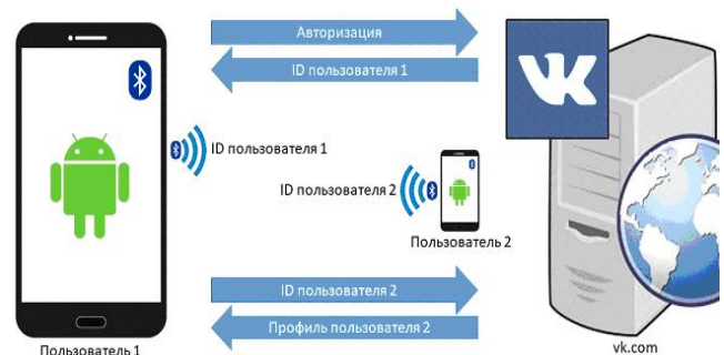
Рис. 3. Схема работы приложения Network Proximity App.
