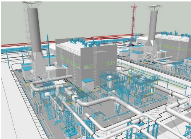
Рис. 1 – BIM газоперекачивающего агрегата [7]
