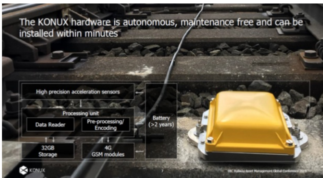
Рис. 44. Внешний вид и характеристики устройств устанавливаемых на путях для сбора данных (источник – KONUX)
