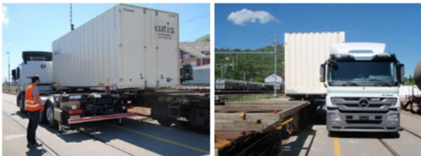
Рис. 16. ContainerMover 4000 для контейнеров грузоподъемностью от 20 до 45 тонн и весом до 34 тонн (источник - Clusters 2.0)
