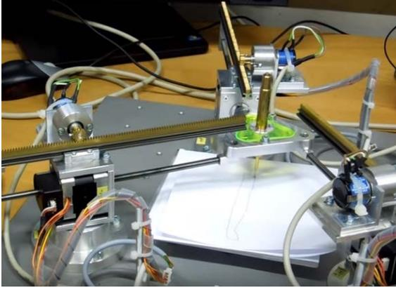
Рис. 1. Робот-манипулятор типа 3-RPR
