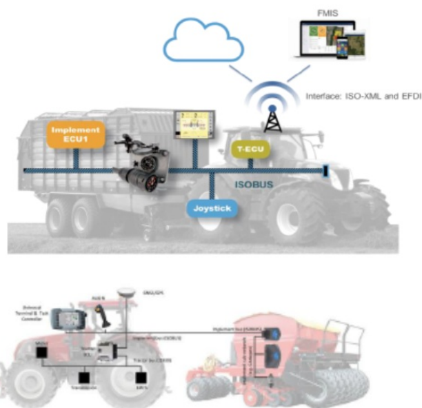
Рис. 12. Типичная система ISOBUS, где ECU трактора является «калькулятором работ» трактора. Это обеспечивает информацию, такую как скорость, частота вращения двигателя и т.д. [17].
