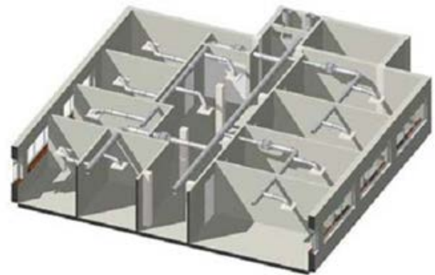
Рис. 12 – 3D вид системы воздухопроводов HVAC (источник: ArchieFM)
