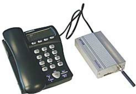
Рисунок 7. GSM модем можно подключить к телефонному аппарату и использовать в качестве мобильного телефона
