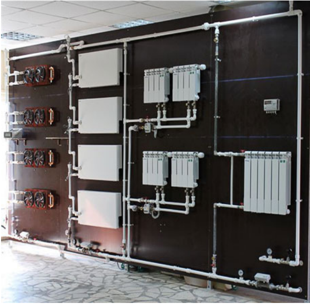
Рисунок 12. Испытательный тепловой стенд элементов энергосберегающих систем (МИЭТ).
