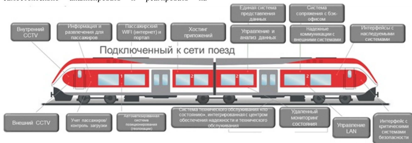
Рис. 10. Основные информационно-телекоммуникационные системы подключенного к сети поезда.
