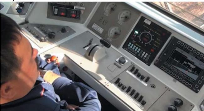
Рис. 2. Следование в режиме автоведения на электровозе 3ЭС5К «Ермак» с грузовым поездом в режиме автоведения на участке Хабаровск-2 — Ружино [7]
