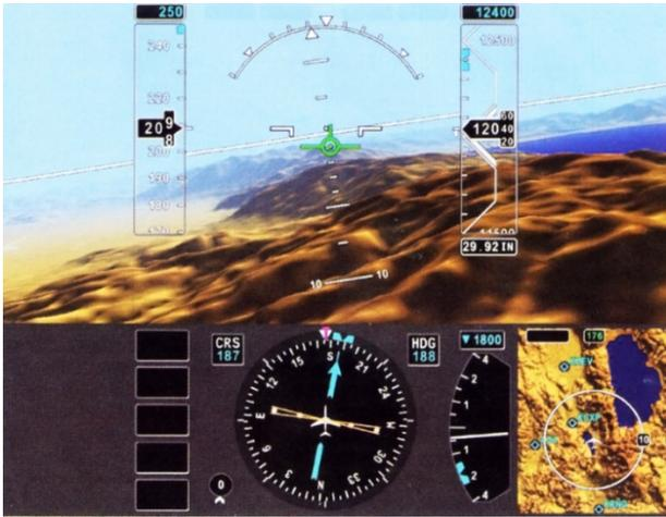
Рисунок 2. Синтезированное изображение, формируемое ССВ "Flight Logic" фирмы Honeywell [3]
