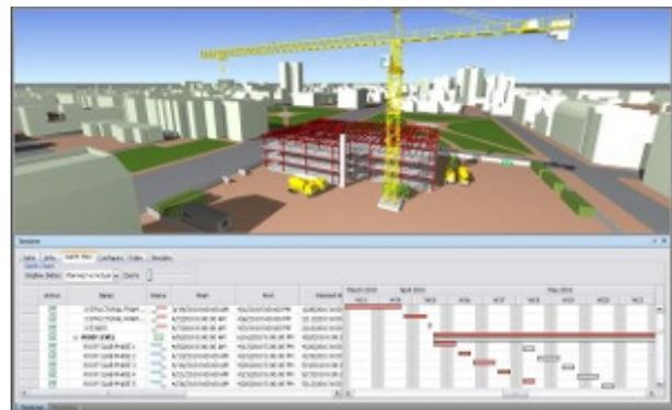
Рис. 4. Интеграция информационной модели сооружения и плана-графика выполнения работ.
