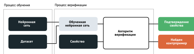
Рис. 2. Блок-схема принципа формальной верификации нейронной сети
