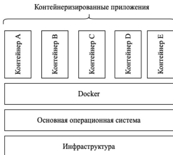
Рис.2. Место контейнера в архитектуре виртуализации
