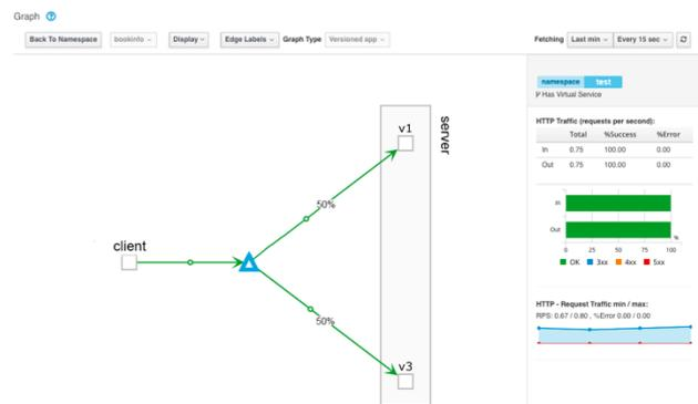
Рис.5. Сетевое взаимодействие компонентов после отключения сервера v2.
