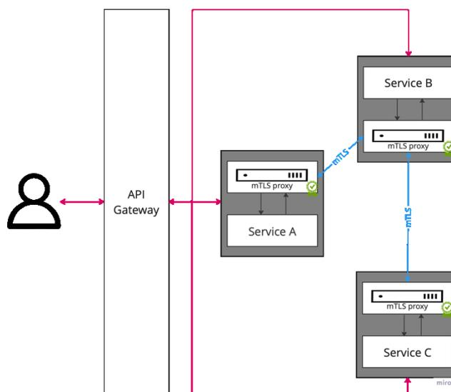
Рисунок 6. Архитектура межсервисной аутентификации с использованием mTLS прокси
