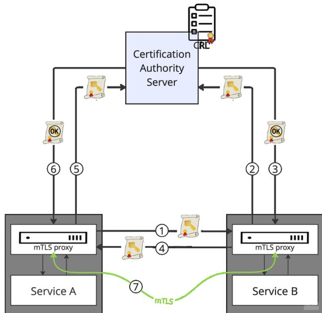
Рисунок 7. Процесс проверки сертификата для архитектуры межсервисной аутентификации с использованием mTLS прокси
