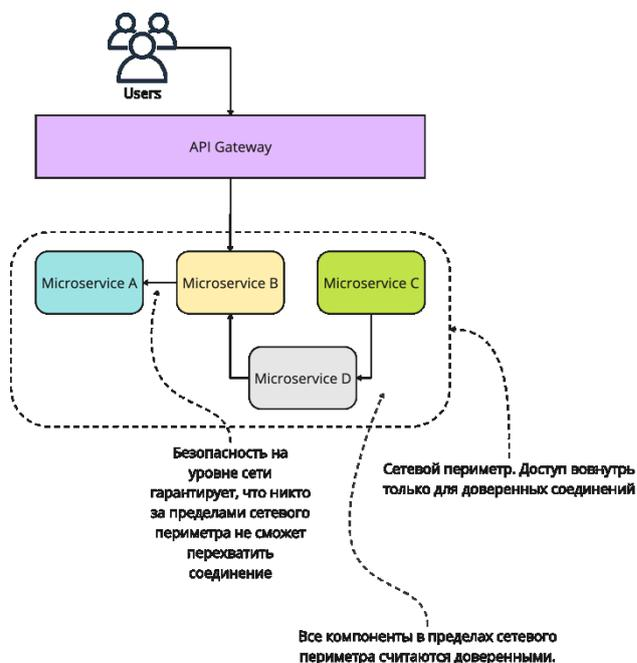
Рисунок 1. Архитектура подхода с использованием доверенных сетей
