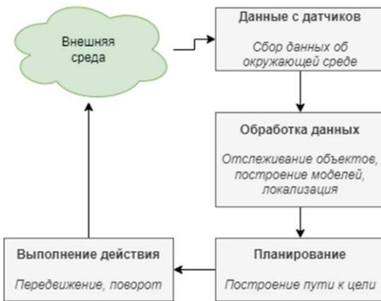
Рис. 1. Схема работы алгоритма типа SLAM
