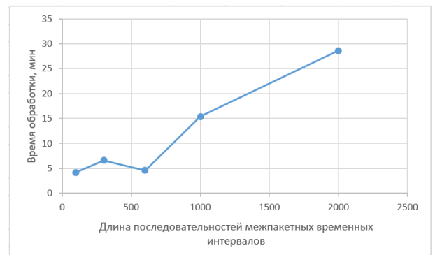
Рис. 5. График зависимости времени обработки сетевого трафика от длины последовательностей межпакетных временных интервалов.
