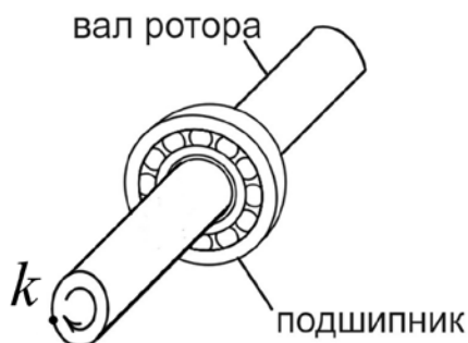
Рис. 4. Вращение вала ротора относительно внешнего, неподвижного кольца подшипника. Точка k вращается с постоянной скоростью по окружности (непрерывное движение). Цилиндрическая поверхность вала (вместе с точкой k ) совершает вибрации (дискретное движение).
