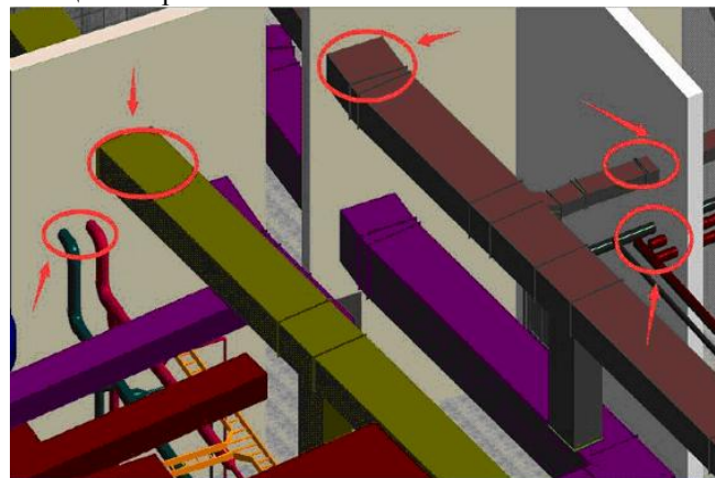
Рис.15. Зарезервированные отверстия основаны на модели BIM [44].
