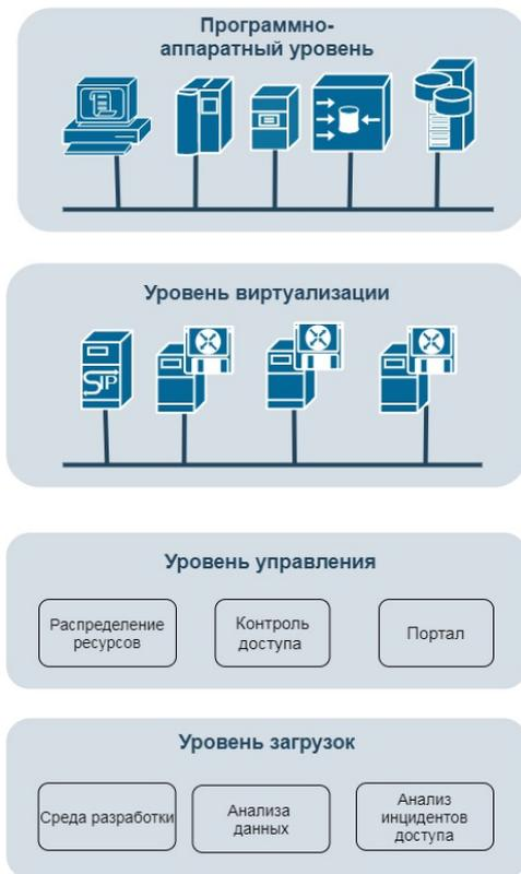
Рис. 3. Абстрактная 4-х уровневая архитектура облачного ВК
