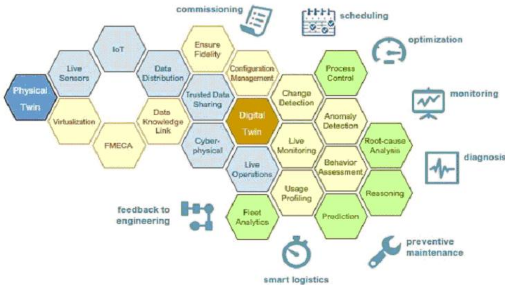
Рис. 10. Общая архитектура цифрового двойника МТК. (источник - https://www.change2twin.eu/digital-twin/ )
